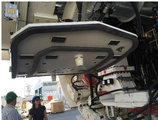
Rys. 5. Erektor – dźwig próżniowy do montażu żelbetowych segmentów obudowy tunelu [fot. autor].
