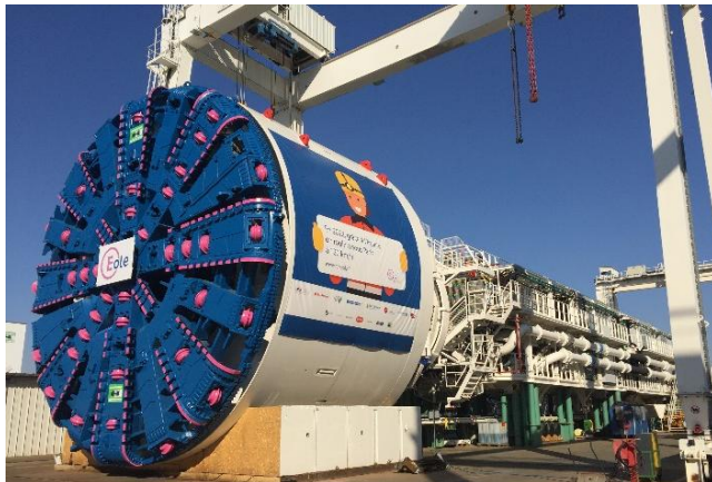
Rys. 3. Głowica skrawająca tarczy typu EPB, średnica 12 m, za nią zaplecze (pociąg) [fot. autor].
