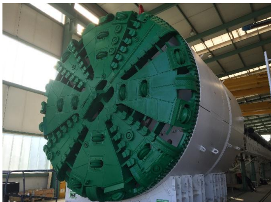
Rys. 1. Tarcza – widoczna głowica skrawająca i powłoka tarczy [fot. autor].
