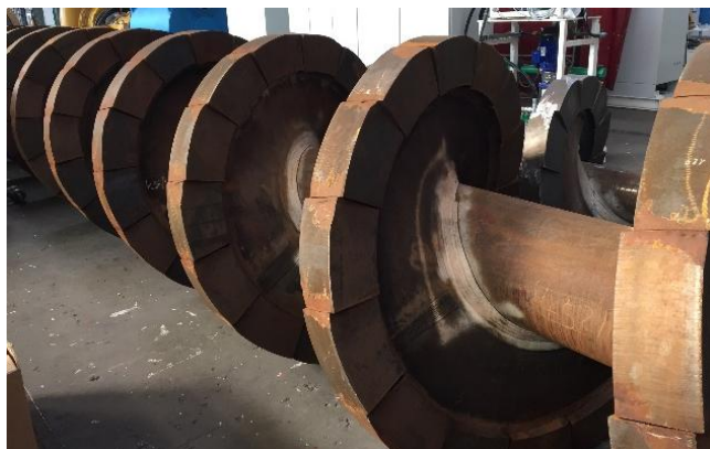
Rys. 6. Widok ślimaczniczy przed zamontowaniem w przenośniku ślimakowym [fot. autor].
